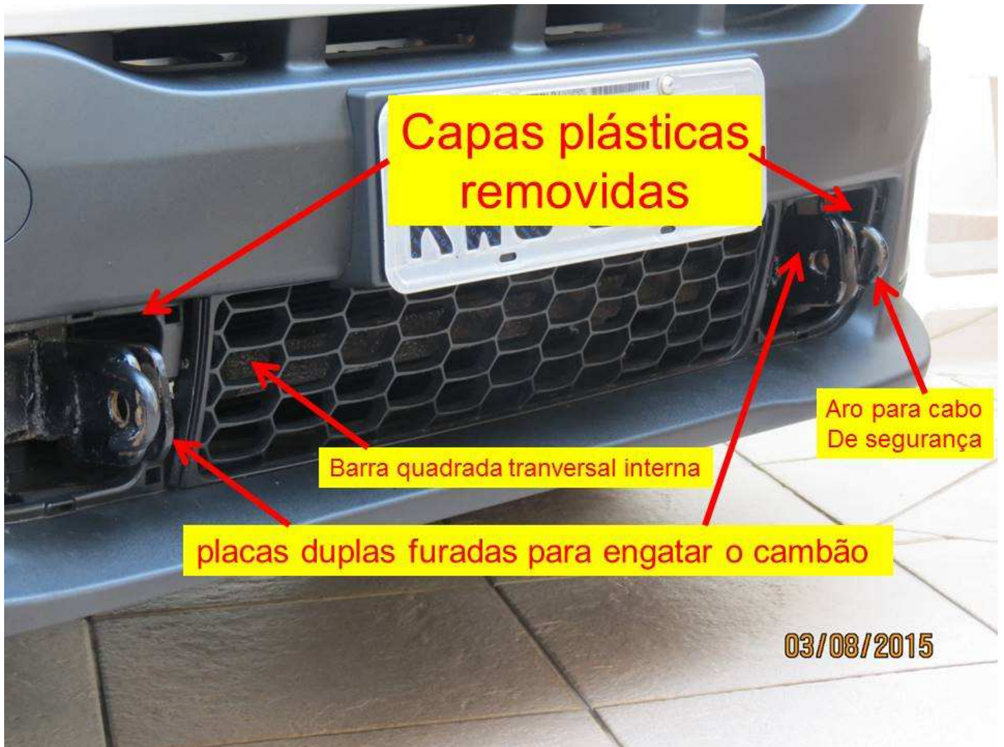
Engate instalado no Renegade (capas plásticas originais foram removidas)
